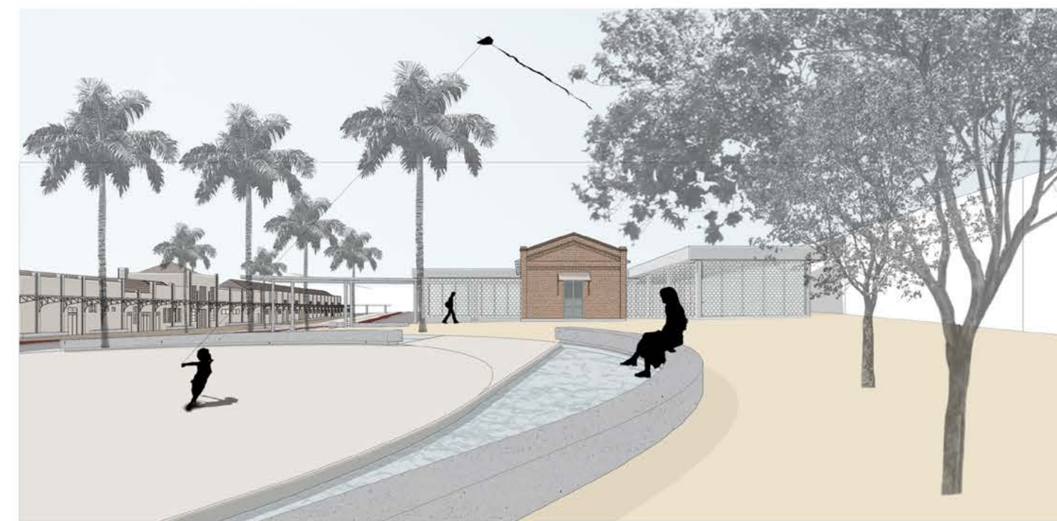
PLATIBANDA DO EDIFÍCIO ANEXO SEGUINDO A MESMA COTA DO ACABAMENTO DA FACHADA DO ARMAZÉM
